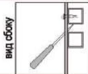
**3** Отрежьте по горизонтали излишний СПК, выходящий за верхнюю границу торца, под углом  $90^\circ$
